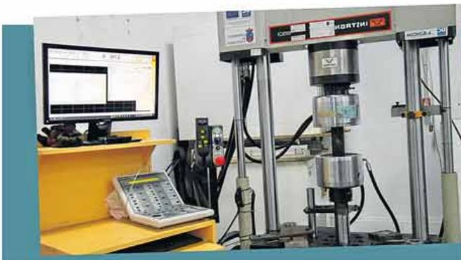
Máquina servohidráulica dinámica
